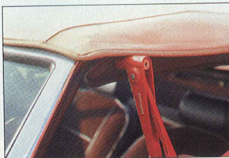
Mit einem Blindniet wird die obere Dichtung der Seitenscheibe am Gestänge befestigt.
