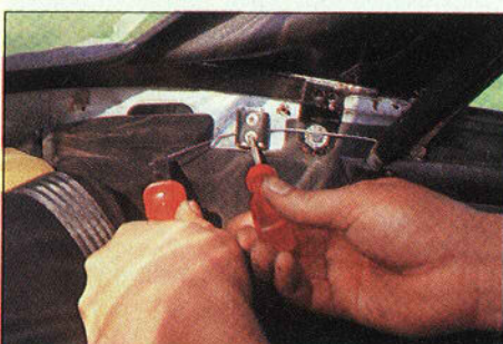
Die seitlichen Spanndrähte verhindern, daß die seitlichen Verdeckkanten im Fahrtwind flattern.
