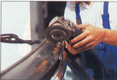
Der besonders anfällige erste Spiegel zeigt oft Rostansatz. In diesem Fall genügt Abschleifen.
