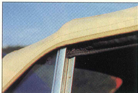
Auch oben, an der versenkbaren „B-Säule“ wird die Stoffhaut angenietet.
