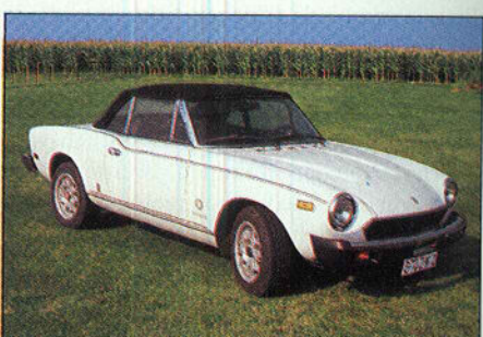
Das zweite Dach ließ den Fenstern mehr Platz und war insgesamt zwei Zentimeter länger!
