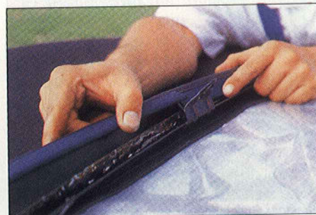
Einfaches Prinzip beim Fiat: Eine Blechschiene hält die Leisten unterhalb der Heckscheibe.
