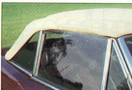
Die Stunde der Wahrheit: Beim Schließen der Tür klemmt die Scheibe das Verdeck ein.
