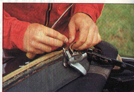
Das alte Dach wird von den Spiegeln heruntergerissen. Verdünnung löst Kleberreste.
