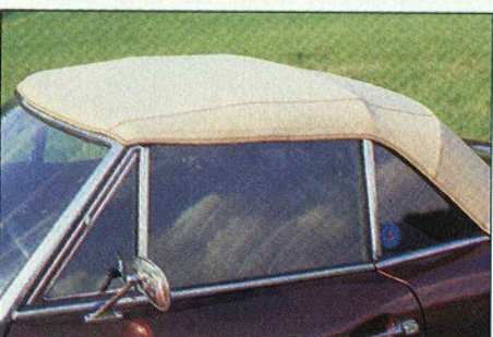
Dieses Dach hat sehr flache Fensterausschnitte. Beide Seitenscheiben blieben hängen.
