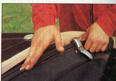
Die gereinigte und entfettete vordere Dichtung wird wieder eingeklebt.
