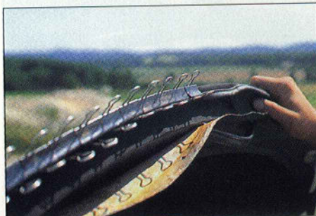
Unglaublich, aber wahr: Damit die Kante später gut sitzt, muß sie beim Kleben nach unten zeigen!
