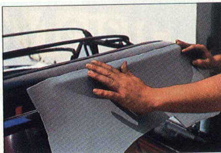
Schönheits-Tip: Der „Dachdecker“ klebt dünnen Schaumstoff auf die vordere Spriegelkante.
