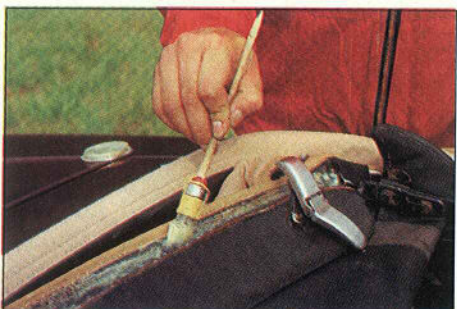
Flüssiger Spezialkleber vom Sattler ist kein Wundermittel — es geht auch mit Pattex.
