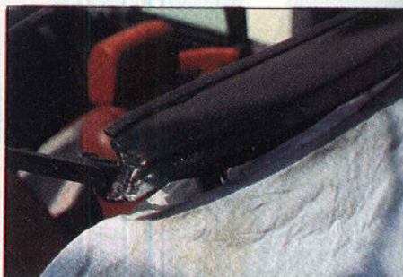
Nach Rostschutzanstrich und Lackierung aus der Sprühdose sieht der Spiegel wie neu aus.
