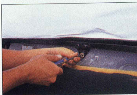
Beim Fiat 124 Spider wird die Halteschiene von innen mit der Karosserie verschraubt.
