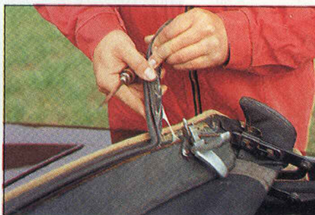
Zuerst wird die vordere Gummidichtung entfernt. Mit etwas Vorsicht läßt sie sich wiederverwenden.
