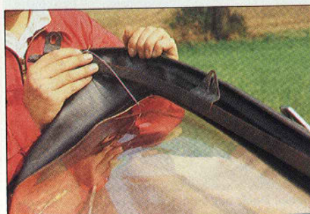
Achten Sie vor dem Anschrauben der Schiene auf den richtigen Verlauf der Spanndrähte.
