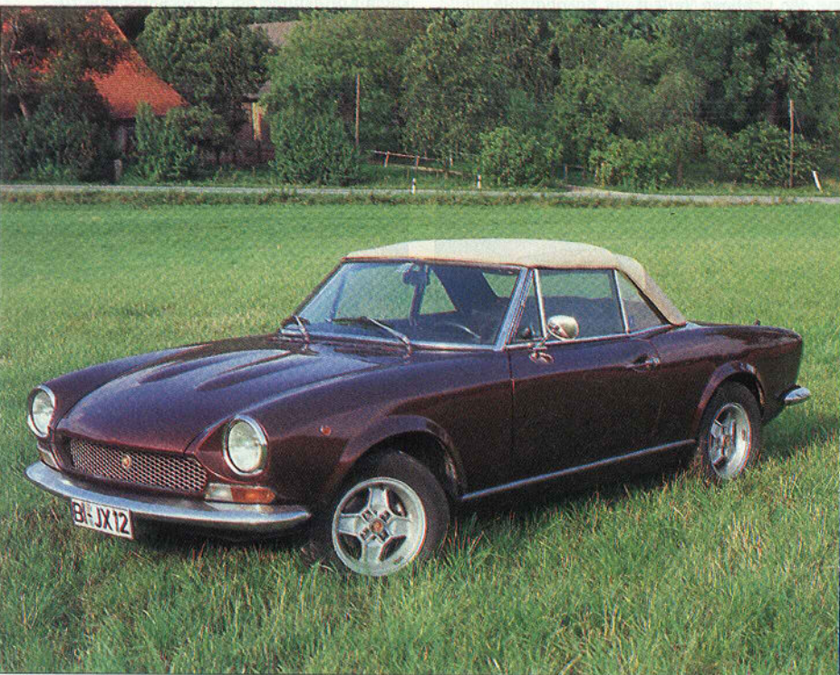
Durch die Spannung hat sich die umgelegte Vorderkante in die richtige Position geschoben. Nachdem das Gestänge insgesamt höher gesetzt worden war, paßten auch die Fensterausschnitte einigermaßen.
