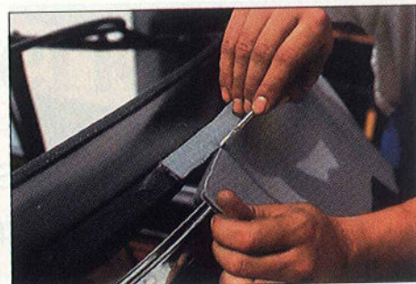
Das Polster sorgt für eine glatte Dachkante. Beim Fiat ist sogar eine Sicke dafür vorgesehen.
