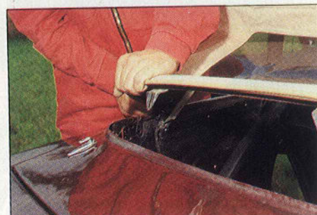
Der Eindruck täuscht: Die Langlöcher lassen kaum Korrekturen am Verdeckabschluß zu.
